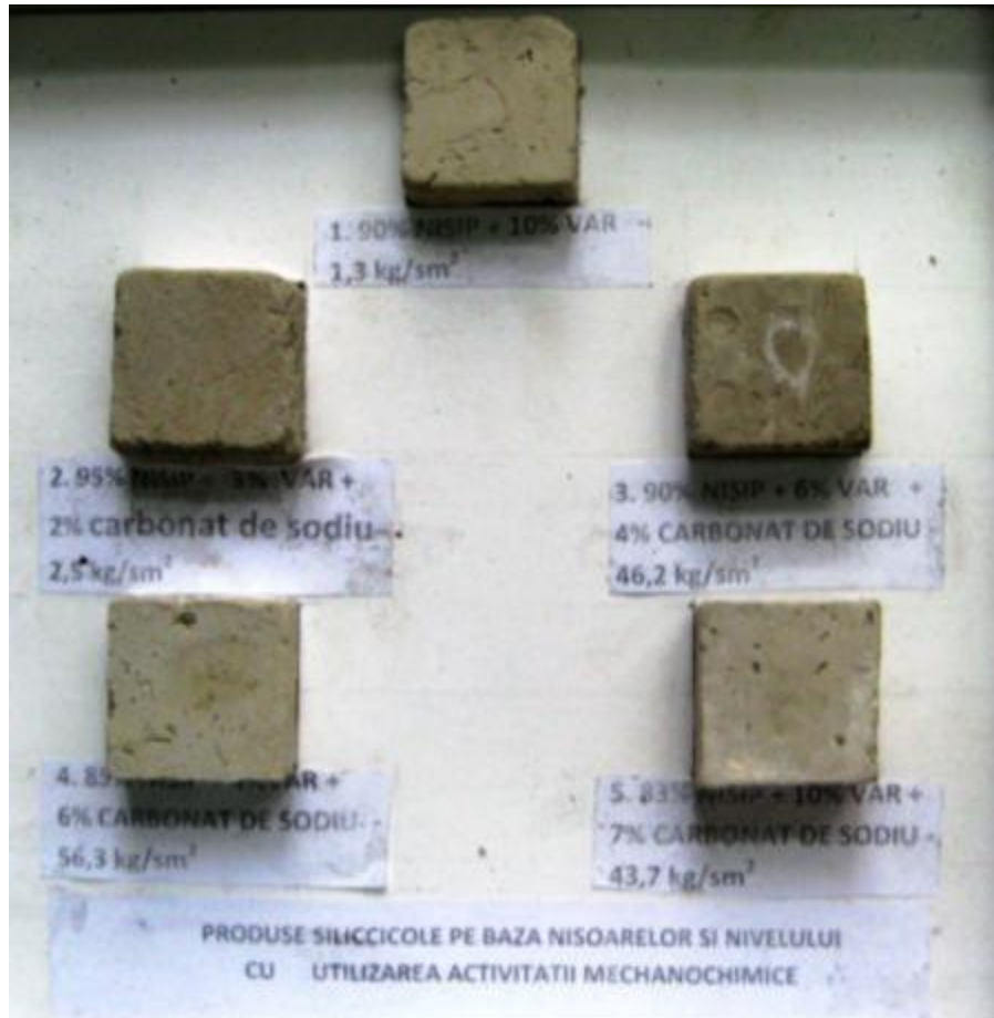
Fig. 1 Materiale silicalcice preparate din amestec de nisip măcinat și calcar activat prin metode mecano-chimice
