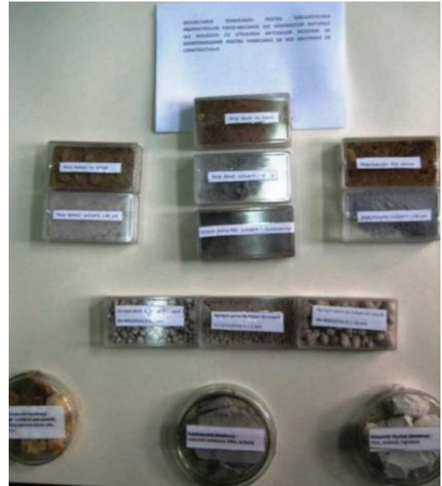
Fig. 2 Mostre de nisip colectate din diferite zăcăminte și ciment alterat activat în condițiile de lichifiere în câmp magnetic alternant
